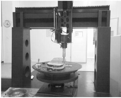
图 4 SiC 非球面反射镜基底的加工实物照片 Fig. 4 Fabrication of SiC aspheric mirror
